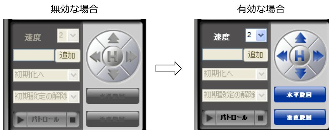
水平旋回：カメラを左右旋回します。
