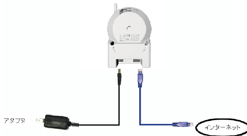
図 2-3 : IP カメラ接続図
