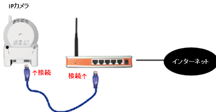
図2-4 : LAN ケーブルをルーターへ接続
